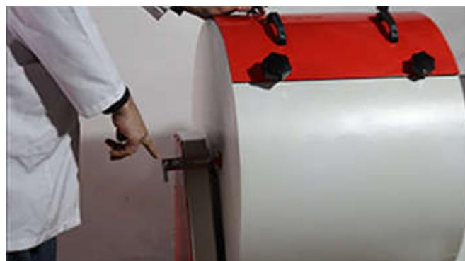
5- Vérifiez que le plateau repose parfaitement dans ses emplacements sur le cadre de base.
